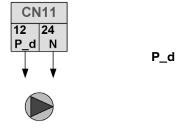
DHW circulation pump (P\_d) Type2 control signal
