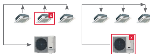
Automatische afpompfunctie waarbij het koudemiddel, bij servicewerkzaamheden, naar keuze naar keuze in de buitenunit of in de binneneenheden kan worden opgeslagen
